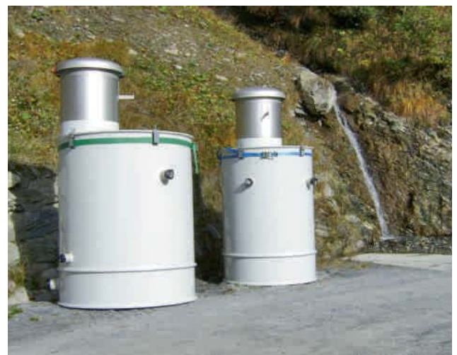
Die HWT-Brunnenstuben warten auf das Versetzen.
